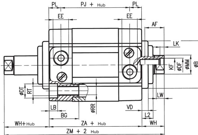
Für die Version mit durchgehender hohler Kolbenstange Variante H im Typenschlüssel
