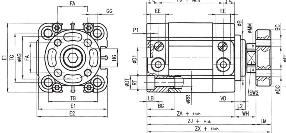
Sollte es sich als nötig erweisen, den Flansch von der Kolbenstange zu lösen, darf der Losschraubkraft ausschließlich unter Verwendung des Sechskantschlüssels SW2 entgegengewirkt werden.
