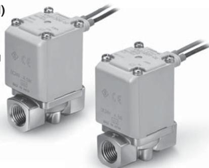
Wenn das Ventil geschlossen ist, wird der Fluss von Anschluss 1 zu Anschluss 2 blockiert. Wenn jedoch der Druck in Anschluss 2 höher ist als in Anschluss 1, kann das Ventil das Medium nicht stoppen und dieses fließt von Anschluss 2 zu Anschluss 1.
