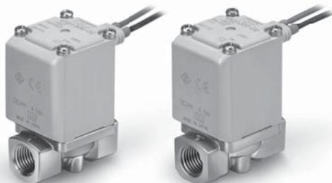
Wenn das Ventil geschlossen ist, wird der Fluss von Anschluss 1 zu Anschluss 2 blockiert. Wenn jedoch der Druck in Anschluss 2 höher ist als in Anschluss 1, kann das Ventil das Medium nicht stoppen und dieses fließt von Anschluss 2 zu Anschluss 1.
